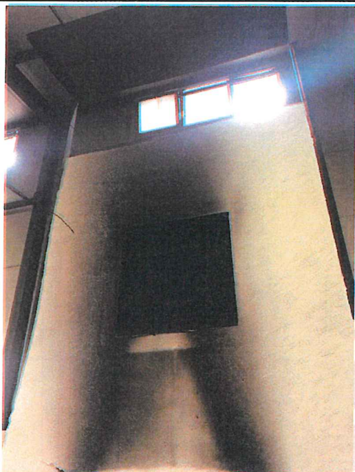
Рис. 10. Внешний вид образца после остывания.
