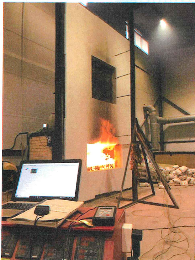
Рис. 4. Внешний вид образца на 10-й минуте испытания.
